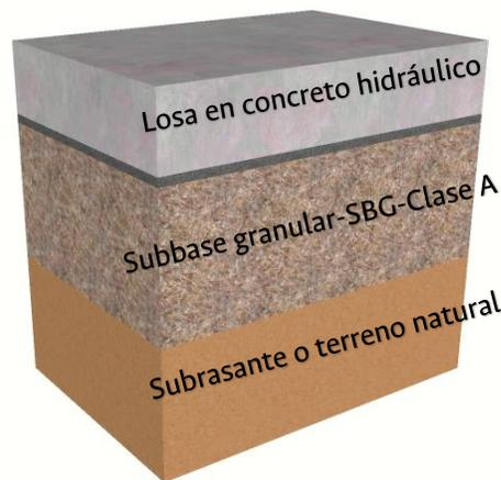
Figura 53. Esquema de las estructuras
